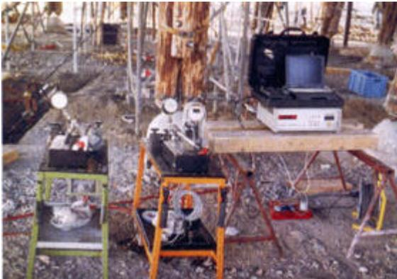
27) "Bild 33. Meßstand mit Hydraulikpumpenwagen und Online Meßanlage"
